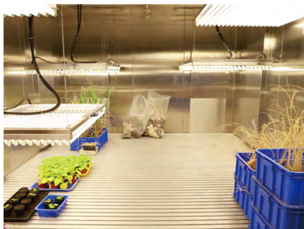
▲生長箱內可調控光線、溫度與濕度
