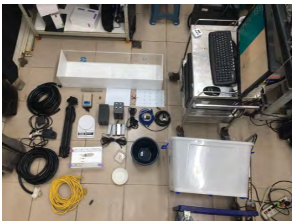
▲水生動物泳動行為影像3D追蹤設備，包括鏡頭腳架、3D滑軌、雷射定位、光源校正等儀器
