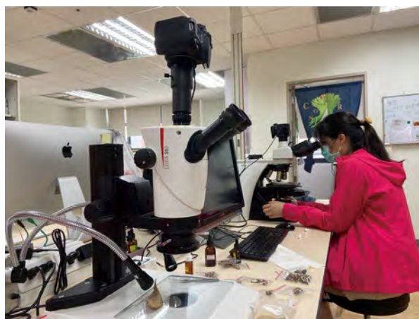
▲解剖及複式顯微鏡為研究苔蘚及真菌不可或缺的儀器（陳可萱攝）
