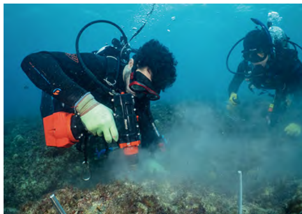
▲水下電鑽可用來採樣和架設實驗器材（蘇淮攝）
