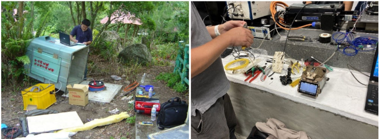
▲圖 4 (上) 光纖地震儀的原理；(下左) 傳統地震站的安裝過程；(下右) 光纖線纜熔接
