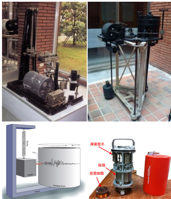
▲圖 1（上左）大森式強震儀 Omori strong motion seismograph；（上右）威赫式水平向地震儀（Wiechert horizontal seismograph），以上兩機械式地震儀早期使用於宜蘭與新港觀測所，現存放於中央研究院地球科學研究所；（下左）地震儀記錄地震的原理，利用彈簧吊掛質體，當地震發生時，質體因慣性作用保持不動，而與滾筒紙產生相對運動並留下紀錄，為了能夠完整地描述三度空間中地震波動行為，實務上地震儀有獨立三分量來觀測東西、南北及垂直三個地震動方向（圖節錄自美國地震學研究機構聯合會網站）；（下右）美國 Teledyne Geotech 公司的 S-13 電磁式地震儀，圖中的感應線圈透過彈簧懸吊並置於磁鐵內，整體設計可靠耐用，本所曾使用於臺灣遙記式地震觀測網（1973 - 1990 年），氣象局亦用來進行地震定位
