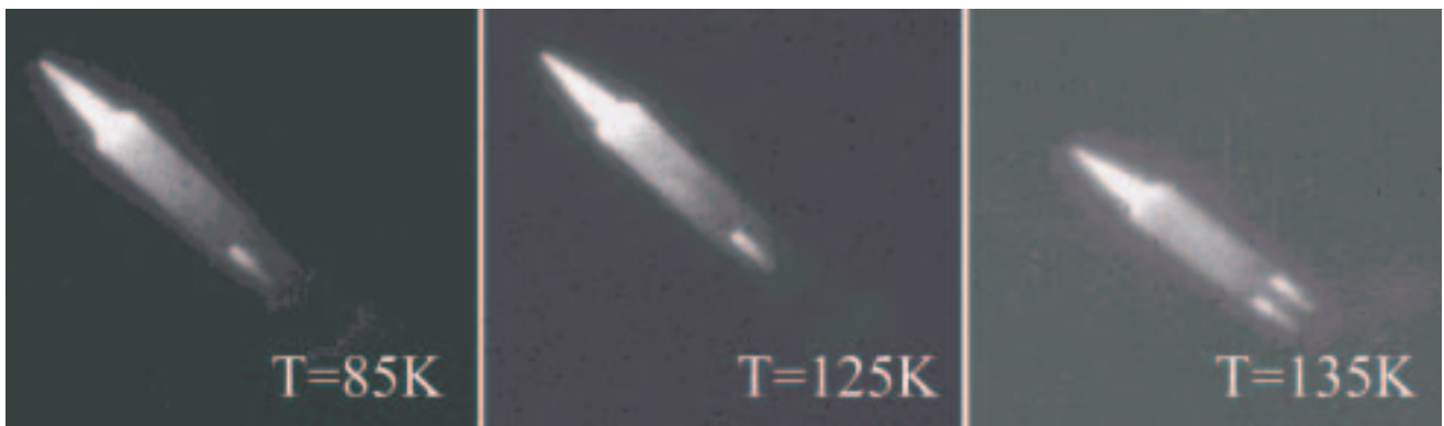
Fig. 2 MWIR thermal images of the 256x256 QDIP FPA.
