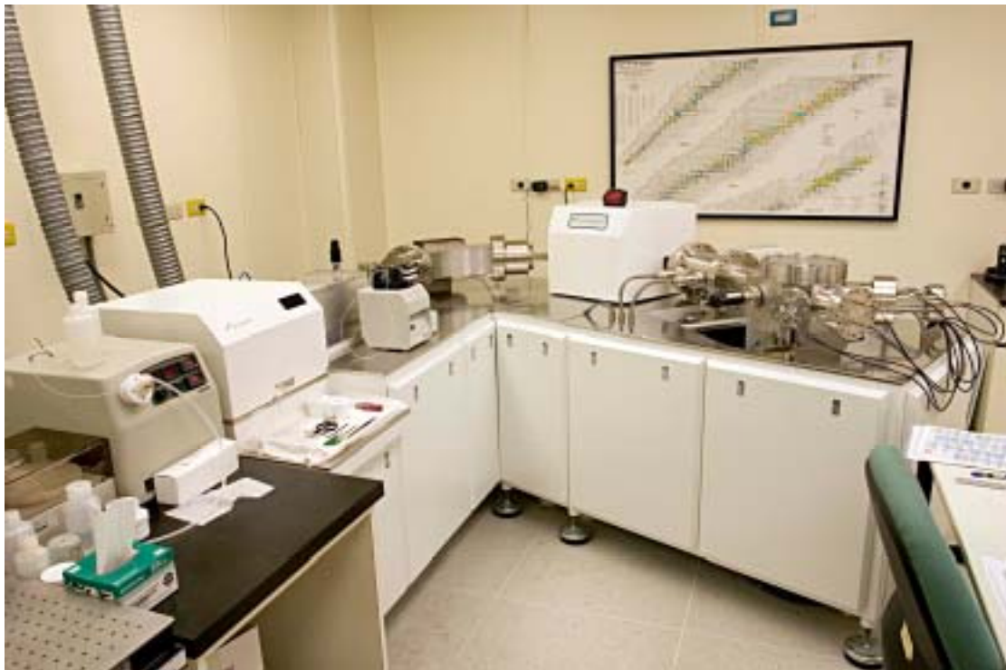
圖二 地球科學研究所購自 Nu-Plasma, UK, 之新一代的電漿離子源質譜儀。
