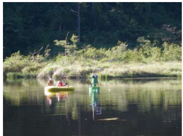
圖一 藉由搭載監測儀器和無線數位傳輸系統的浮筒，可有效監測氣象變動下瞬間的水文變化。
