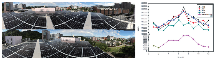
圖5：活動中心頂樓單晶矽與薄膜式太陽能電池發電差異測試場與測試結果
