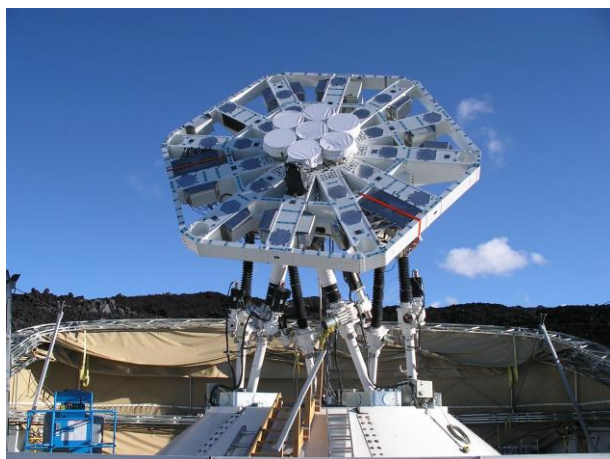
圖一：位於夏威夷 Mauna Loa Observatory 的宇宙背景輻射陣列，攝於 2006 年 9 月。7 具口徑 60 公分的微波接收機天線已安裝至約六公尺寬的史都華六軸平台上 (Steward Platform)。平台由碳纖維材料製成，其上裝置了望遠鏡的各種重要元件。預計兩年後，陣列天線數目將增加到 13 具，而且天線口徑將從目前的 60 公分增加到 1.2 米。屆時成像的速度與望遠鏡的靈敏度都將大幅的提昇。
