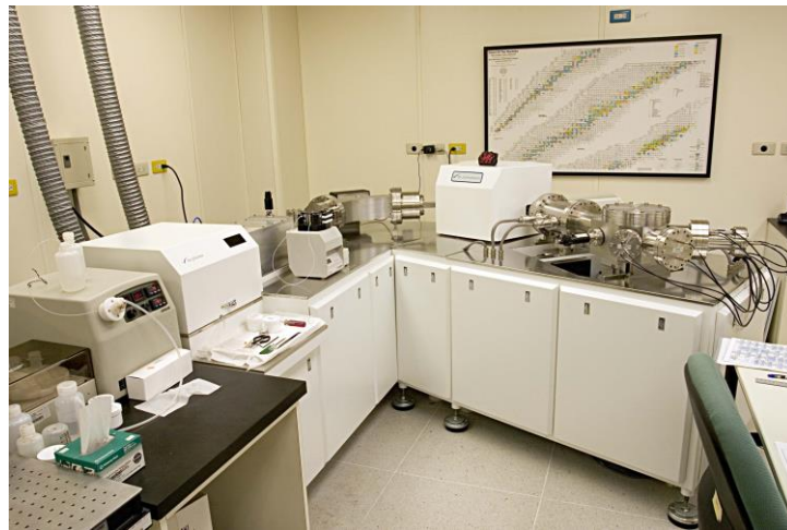
圖二 地球科學研究所購自 Nu-Plasma, UK, 新一代的電漿離子源質譜儀。
