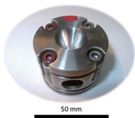
圖一：對稱式高壓鑽石砧。約為一個手掌可以握住的體積。原理為使一對鑽石的尖端砧面互相擠壓，以產生高達數十萬至百萬倍大氣壓的高壓環境。在實驗室裡我們用他來模擬地球內部的高壓狀態，再搭配加熱技術，如同進行一趟地心之旅，一窺材料在地球內部的性質。
