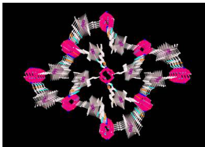
圖三：含甘胺酸分子的配位聚合物具有類似蛋白質的螺旋結構 4b
